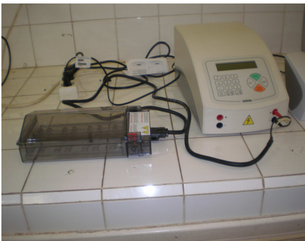
Photo 2 : Générateur branché au bac de migration
