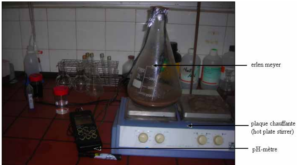
Photo 6: Dispositif d'hydrolyse installé au laboratoire
