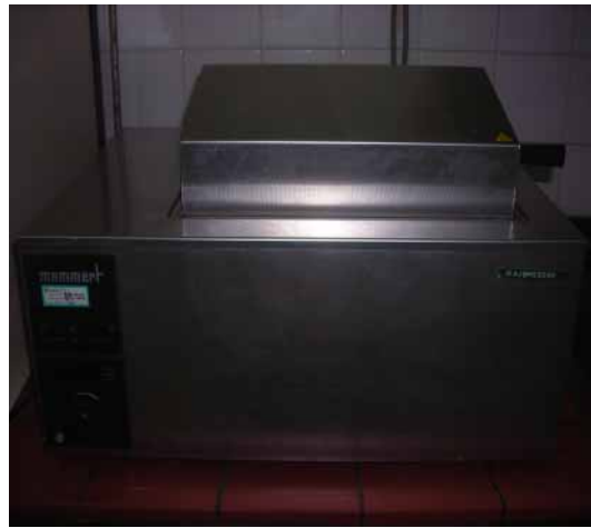
Photo 5 : Bain marie pour l'inactivation de l'enzyme
