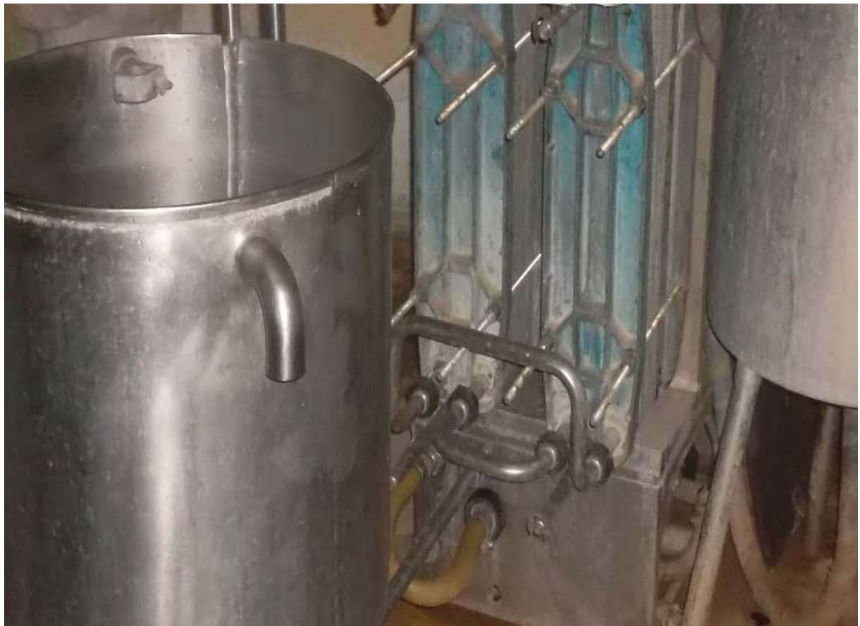
Figure 7 : Pasteurisation du mélange à l'aide d'un pasteurisateur à plaques
