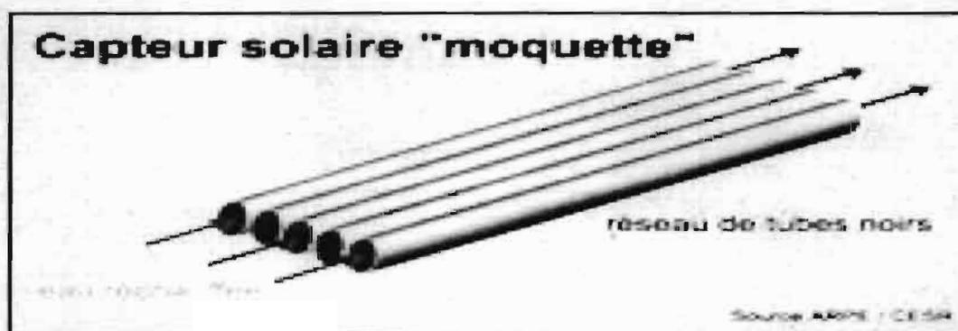
Figure XII.2 : Le capteur non vitré, dit capteur moquette
