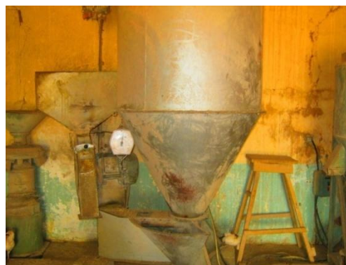
Figure 8 : Mélangeur vertical de la ferme Guidan Gona
