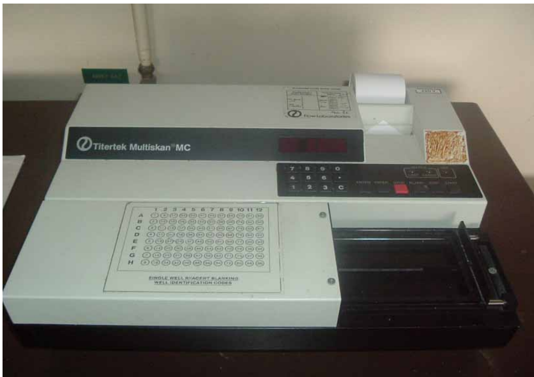
Figure 8 : Lecteur ELISA de type Titertek Multiskan MC
