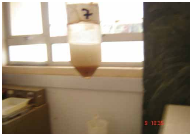
Photo 8 : Séparation de la phase aqueuse (au dessus) de la phase phénolique (en dessous) après ajout du mélange phénol / chloroforme
