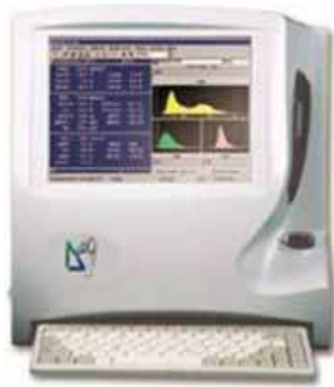
Figure 11: Compteur cellulaire automatique de type MS9-3.Vet [47]
