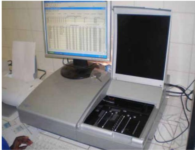
**Figure 13 : Lecture au densitomètre PROG HYDRAGEL PROTEINE**
