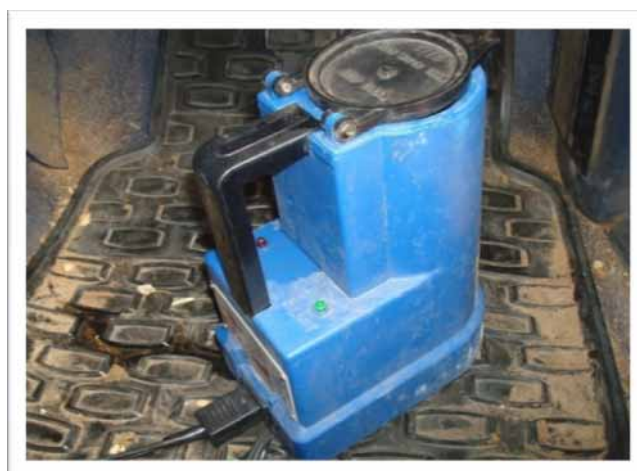
Figure 9 : décongéleur électrique (Photo IBRAHIM O.)
