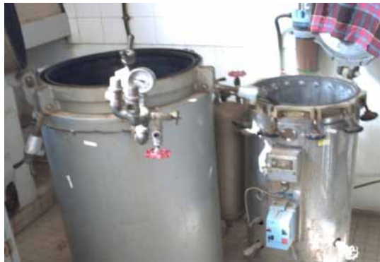
Photo 8: Autoclaves pour la destruction de cultures et de milieux de cultures microbiologiques (Photo: NIYONDAMYA, 2009)
