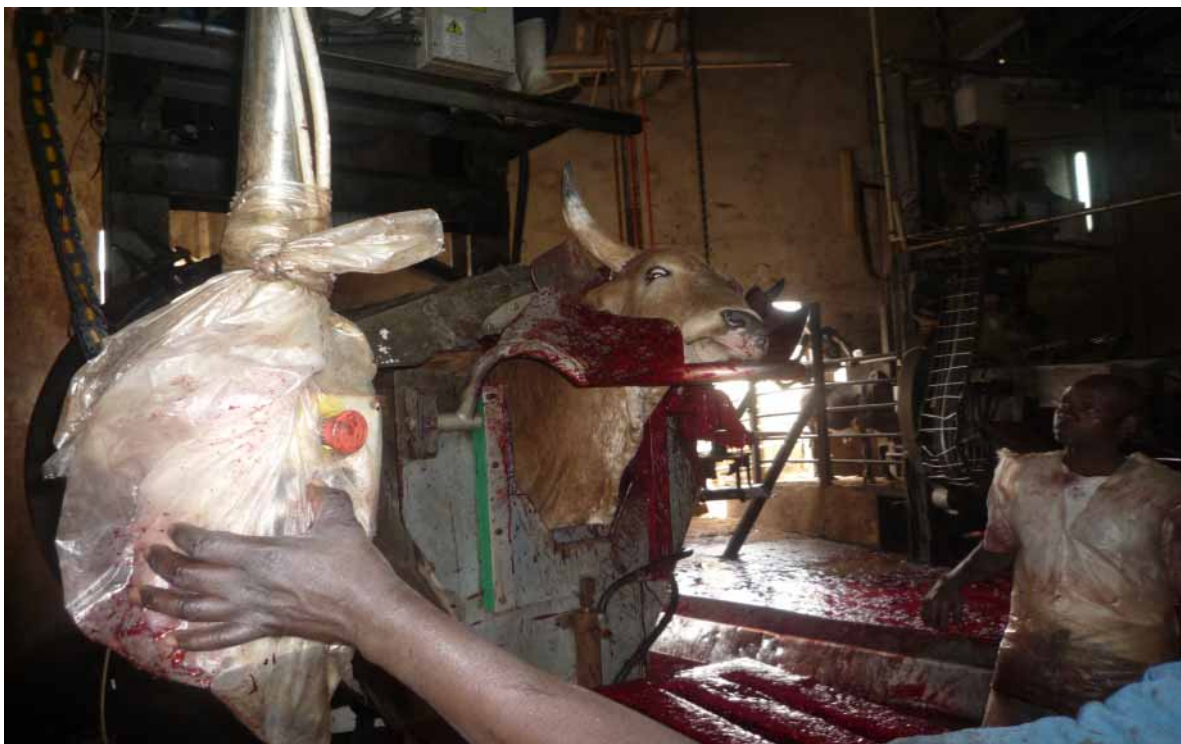
Pivot du box à 90° pour respecter le principe halal (direction la Mecque)
