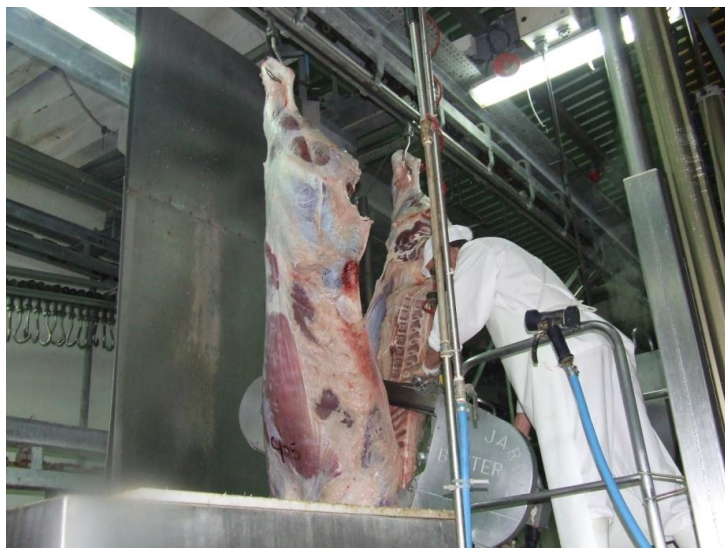
Figure 11 : Fente de bovin à la scie électrique Source : KALLO
