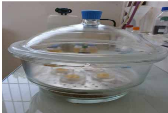
Figure 13: dessiccateur ayant servi au refroidissement des capsules
