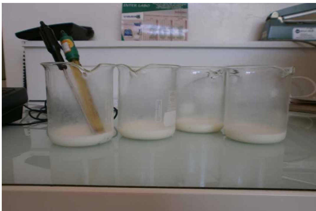
Figure 14: Mesure du pH à l'aide d'un pH mètre
