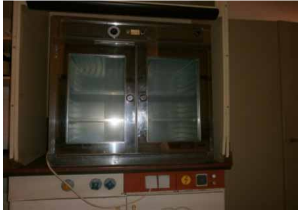
Figure 12: Etuve ayant servi au séchage des capsules (103 \pm 2)^\circ\text{C}
