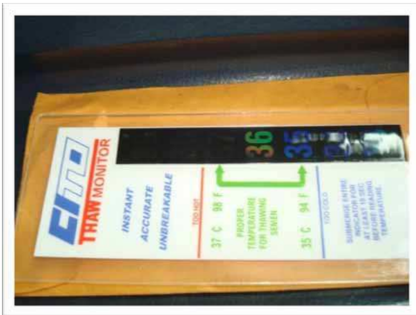
Figure 12 : Testeur température de l'eau (Photo IBRAHIM ,2009)
