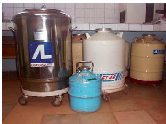
Figure 11: Récipients cryogéniques de congélation de la semence, de conservation des paillettes et de transport des paillettes sur le terrain
