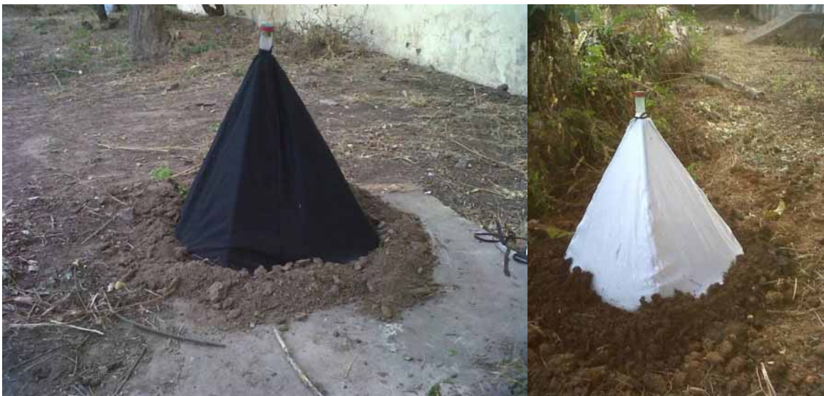
Figure 32 : Piège à émergence de Culicoides de type circulaire posé sur milieux différents dans le haras national de Thiès (Cliché : DUSOM M.).
