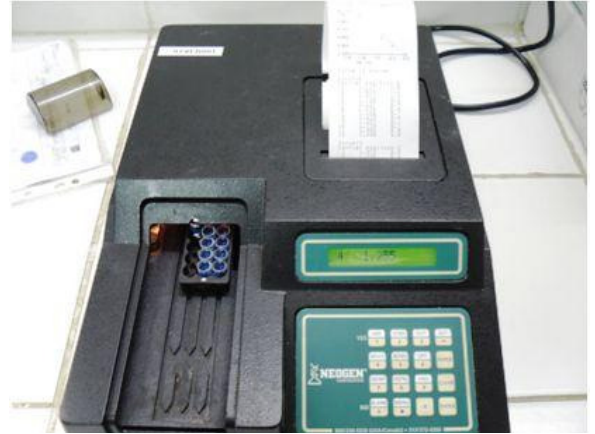
Figure 16 : Ajout de la solution d'arrêt et lecture des résultats avec le lecteur Neogen® corporation
