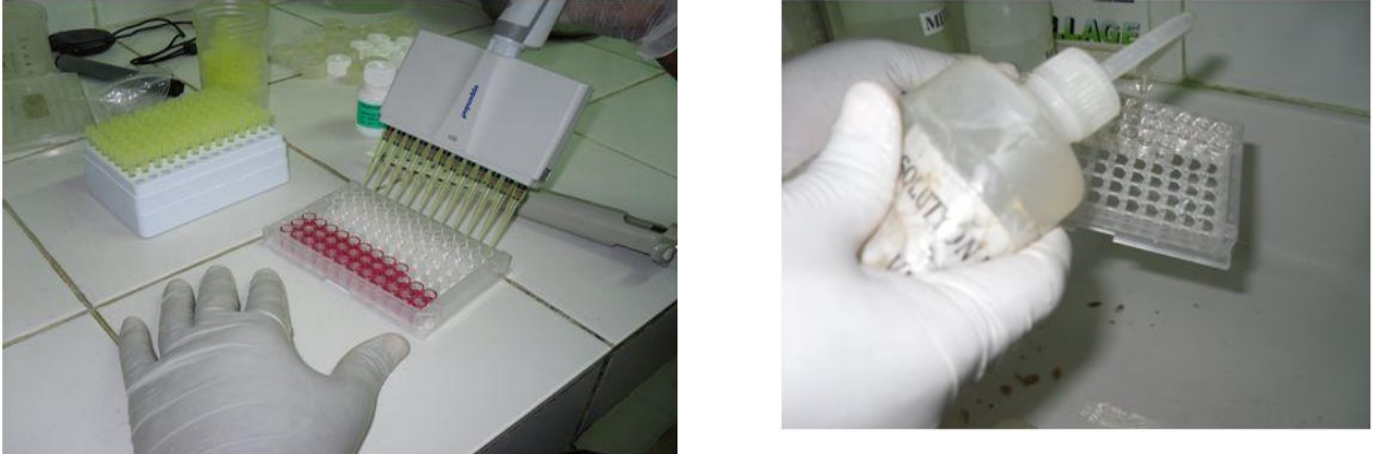
Figure 14 : Transfert dans les tubes blancs contenant les anticorps et lavage de la plaque.
