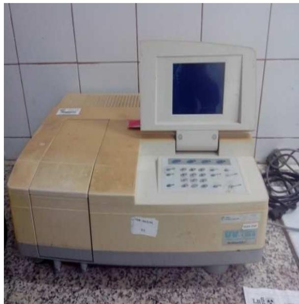
Spectrophotomètre d'absorption UV-visible
