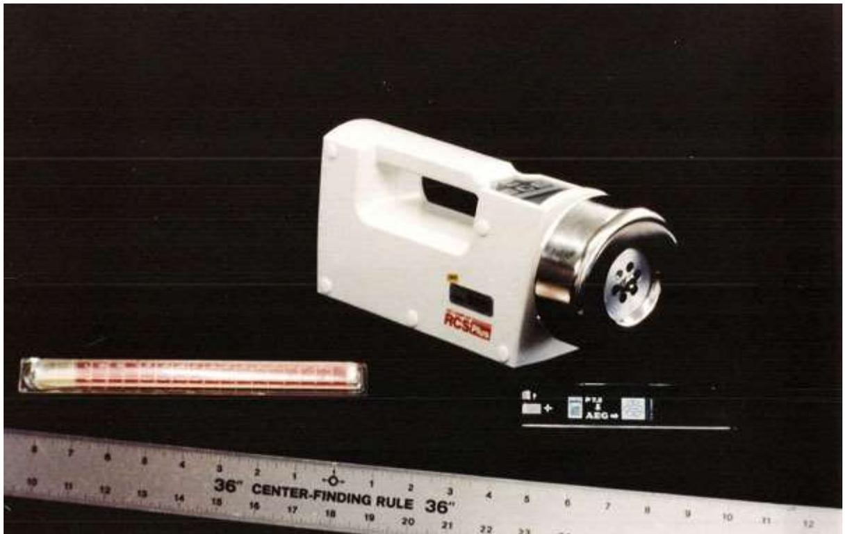
**Figure 1** : Le R.C.S. (Reuter Centrifugal Sampler)
