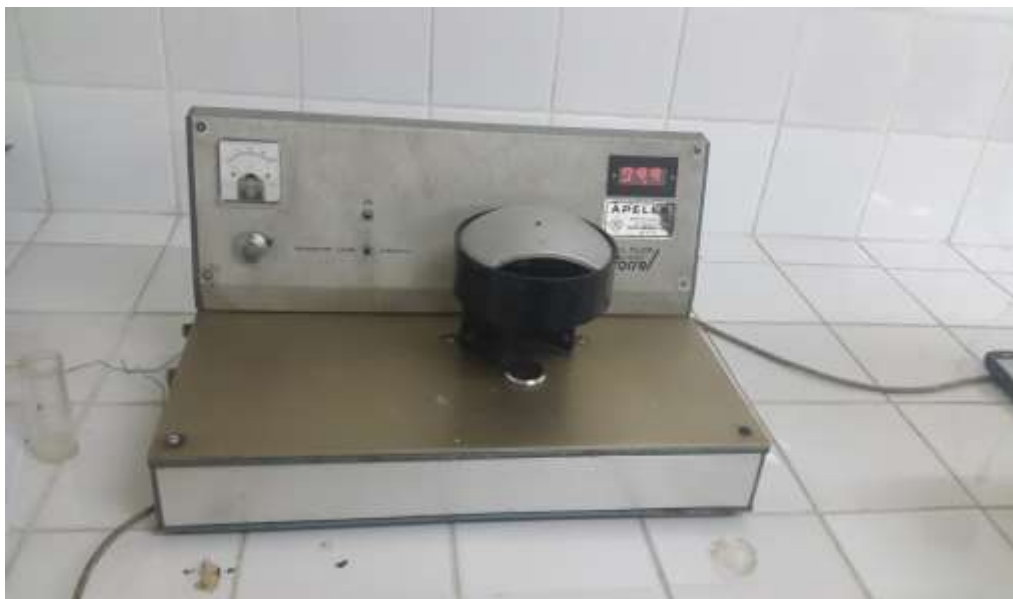
FIGURE 32 : Dispositif expérimental pour le test du TAIL FLICK
