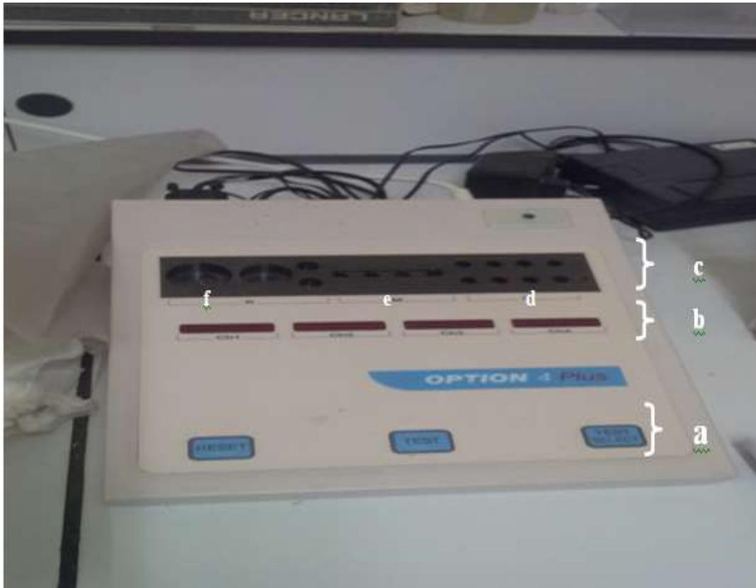
a : touche de fonction (reset, test et test select) ; b : afficheurs canal 1, 2, 3 et 4 ; c : zone thermostatée ; d : zone d'incubation des échantillons – 8 positions, e : zone de mesure – 4 canaux, f : zone d'incubation des réactifs – 2 positions de tailles différentes pour les flacons réactifs et 2 positions pour les cuvettes.
