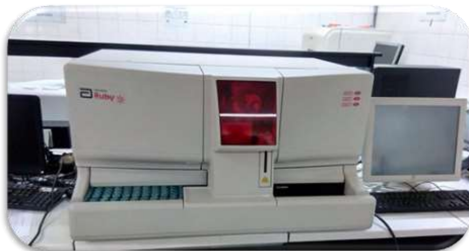
Figure 16 : Automate de numération type Cell Dyn Ruby. Photo prise au laboratoire central du CHU de Yopougon (Unité d'hématologie).
