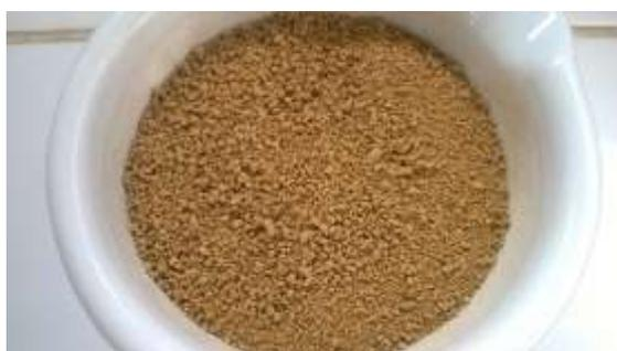
**Photo 8:** Grains secs avec empois d'amidon de blé à 8% après 24 heures à 45°C meilleure dureté et sera retenu comme liant pour la suite de notre expérimentation.
