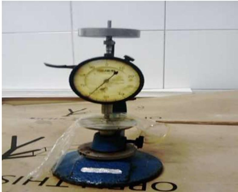
*Figure 4 : Dispositif de mesure de l'épaisseur [Photo LNSP 2017]*
