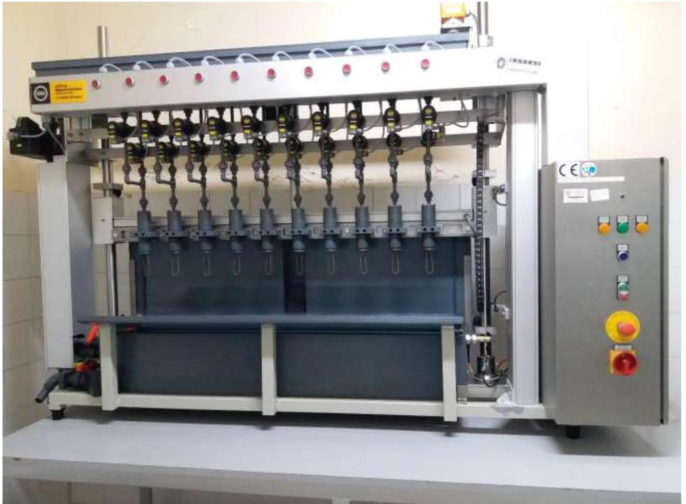
**Figure 7 : Dispositif d'essai électrique de détection de perforations [Photo LNSP 2018]**
