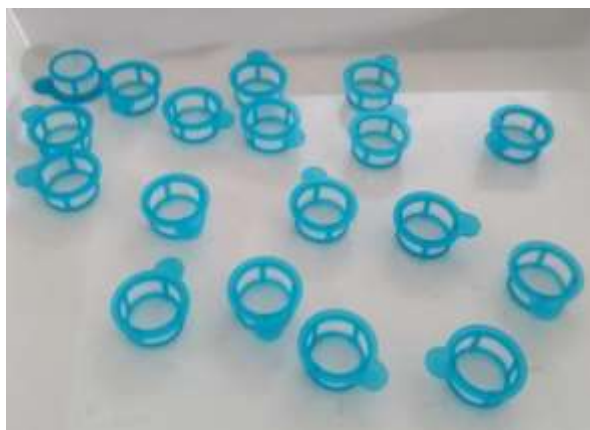
Figure 14 : Filtre de diamètre 40 \mu m
