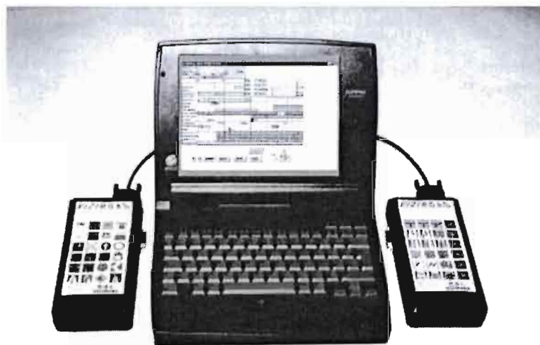
Figure 1: Ordinateur portable muni du logiciel VIZIROAD et équipements connexes
