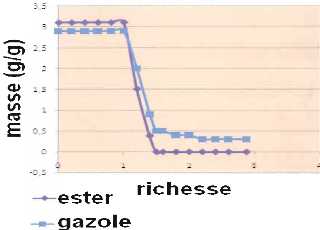
Figure V-6 : comparaison des quantités de CO 2 formées pour le gasoil et l'ester méthylique d'huile de jatropha en fonction de la richesse
