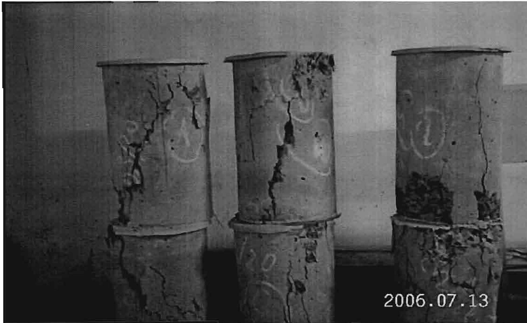
Figure N°10: Aperçu des lignes de rupture après écrasement
