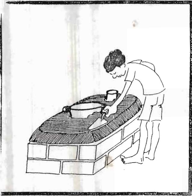
On construit la cuisinière «BAN AK SUUF» autour de la marmite et d'une boîte à conserve ou d'un morceau de bois qui doivent avoir les dimensions de la cheminée prévue (10 à 20 cm de diamètre). Au fur et à mesure qu'on ajoute du mélange on relève un peu à chaque fois la marmite et la boîte de conserve.
