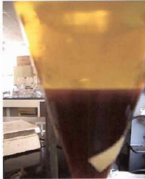
Figure II.4 : schéma de la séparation entre l'ester et le glycérol après réaction
