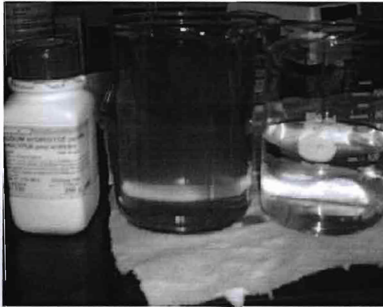
figureA1.1 : éléments de la production de biodiesel : à gauche : NaOH ; au milieu : huile de palme raffinée ; à droite : méthanol
