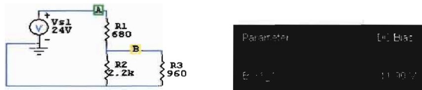
Figure 3.33 : Pont de résistances pour le relais
