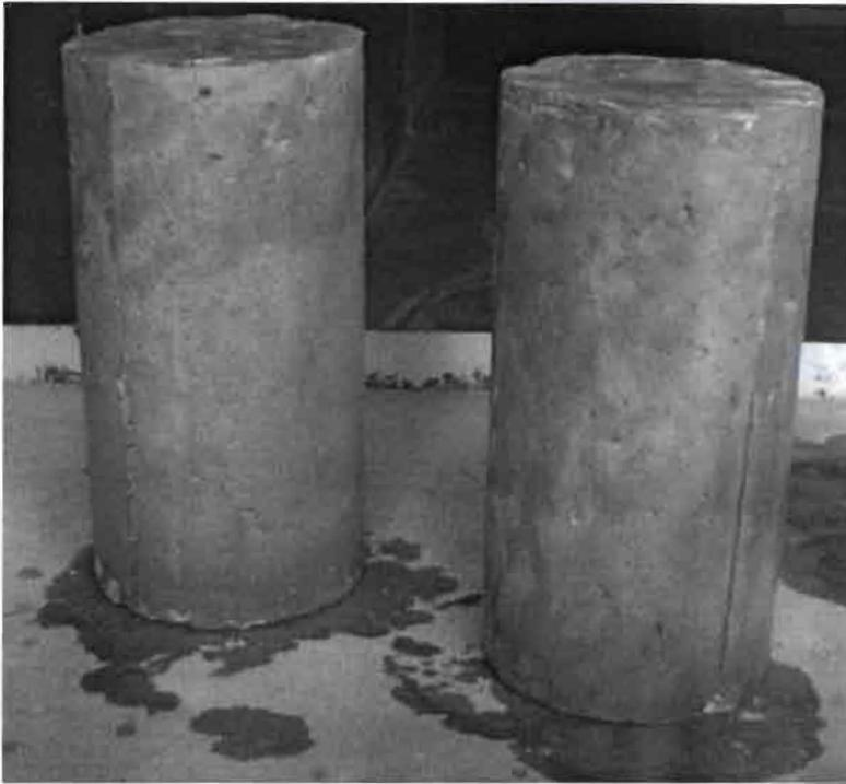
Figure III.13 : Parement des éprouvettes après démoulage avec composition proposée
