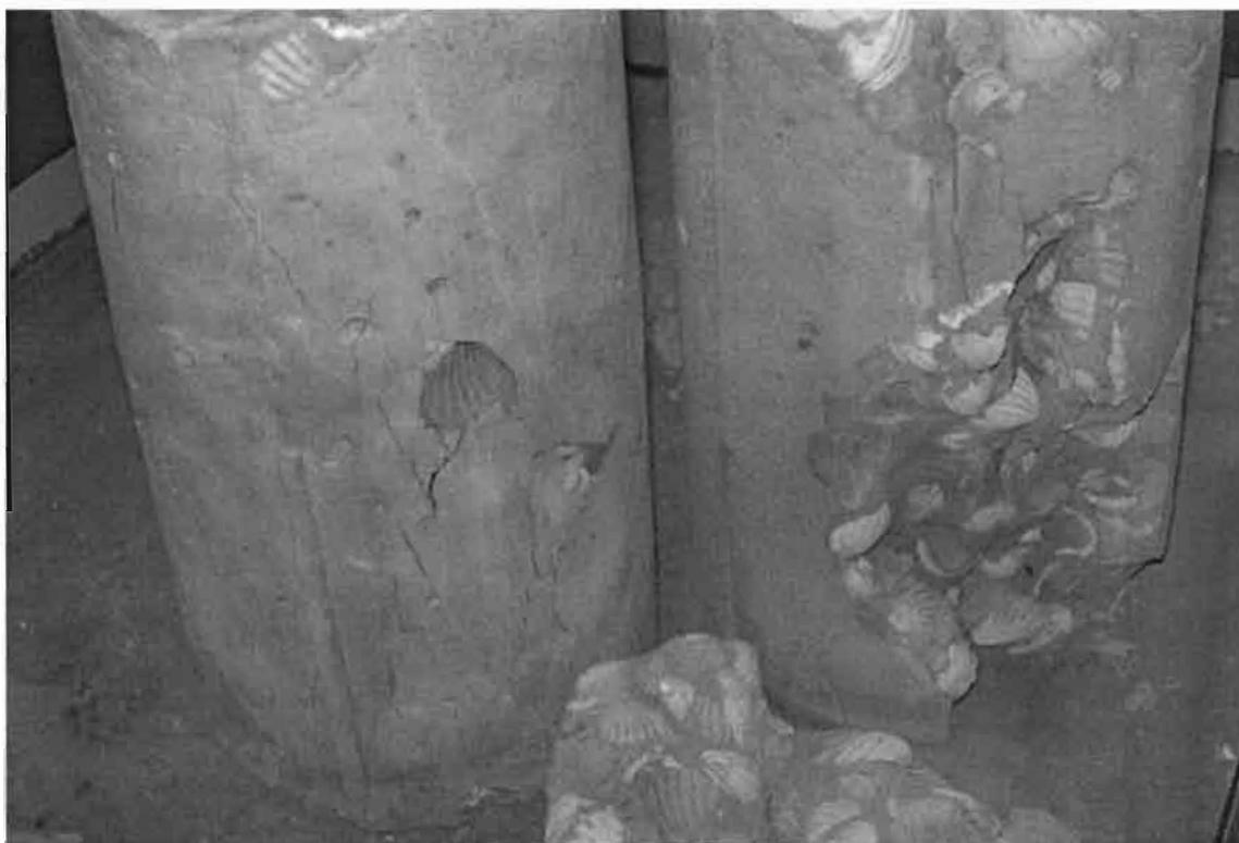
**Figure III.14 :** Aperçu des lignes de rupture après écrasement à la presse
