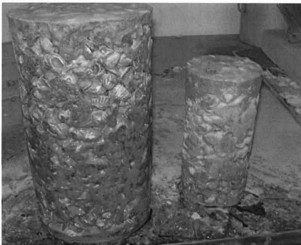
**Figure III.11 :** Parement des éprouvettes après démoulage (classe 8/16 et 16/25) : composition de Dreux
