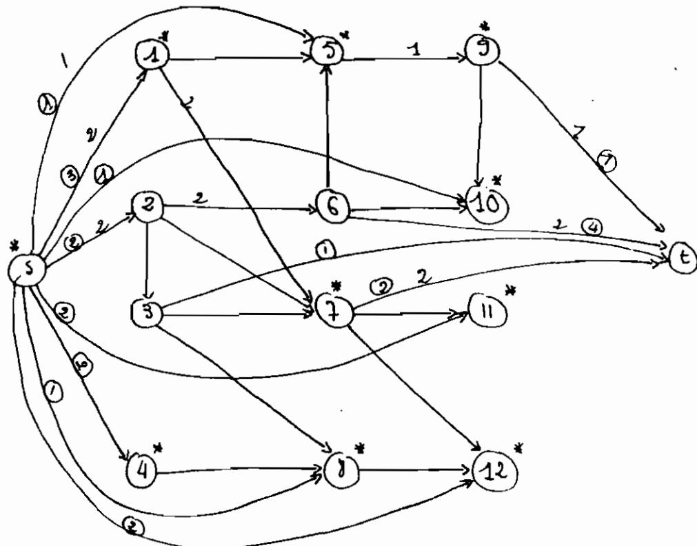
Si on applique l'algorithme de Ford et Fulkerson, on trouve un flot maximal de valeur 5. Des nombres encadrés représentent les capacités des arcs, et ceux qui ne le sont pas, les flots qui y sont envoyés. Des sommets marqués
