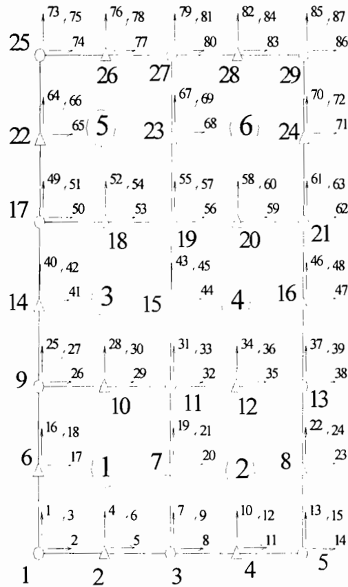
Figure 16: Maillage d'une structure
