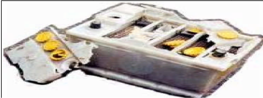
Figure 3:batterie ayant explosé suite à un court-circuit.
