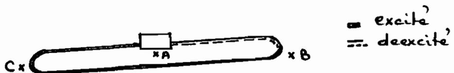
Pour résoudre ce problème il suffit d'envoyer le signal d'excitation quand l'électro-aimant est au point A. Ensuite maintenir l'excitation sur le trajet ACAB. Le signal doit être coupé au point B. On reconnaît aisément la fonction mémoire bistable.
