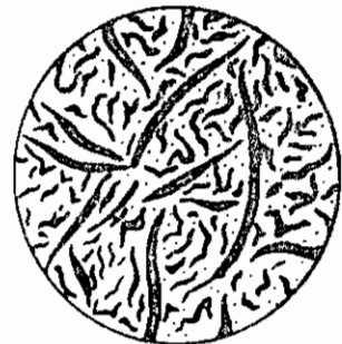
FIG. 30 - Graphite type C (lamelles superposées).
