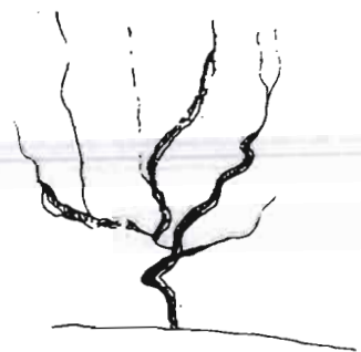
C - Erosion convergente sur sol moyennement résistant.
