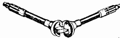
Fig. 15 -- Joint à deux axes non concourants, système TRAPIA
