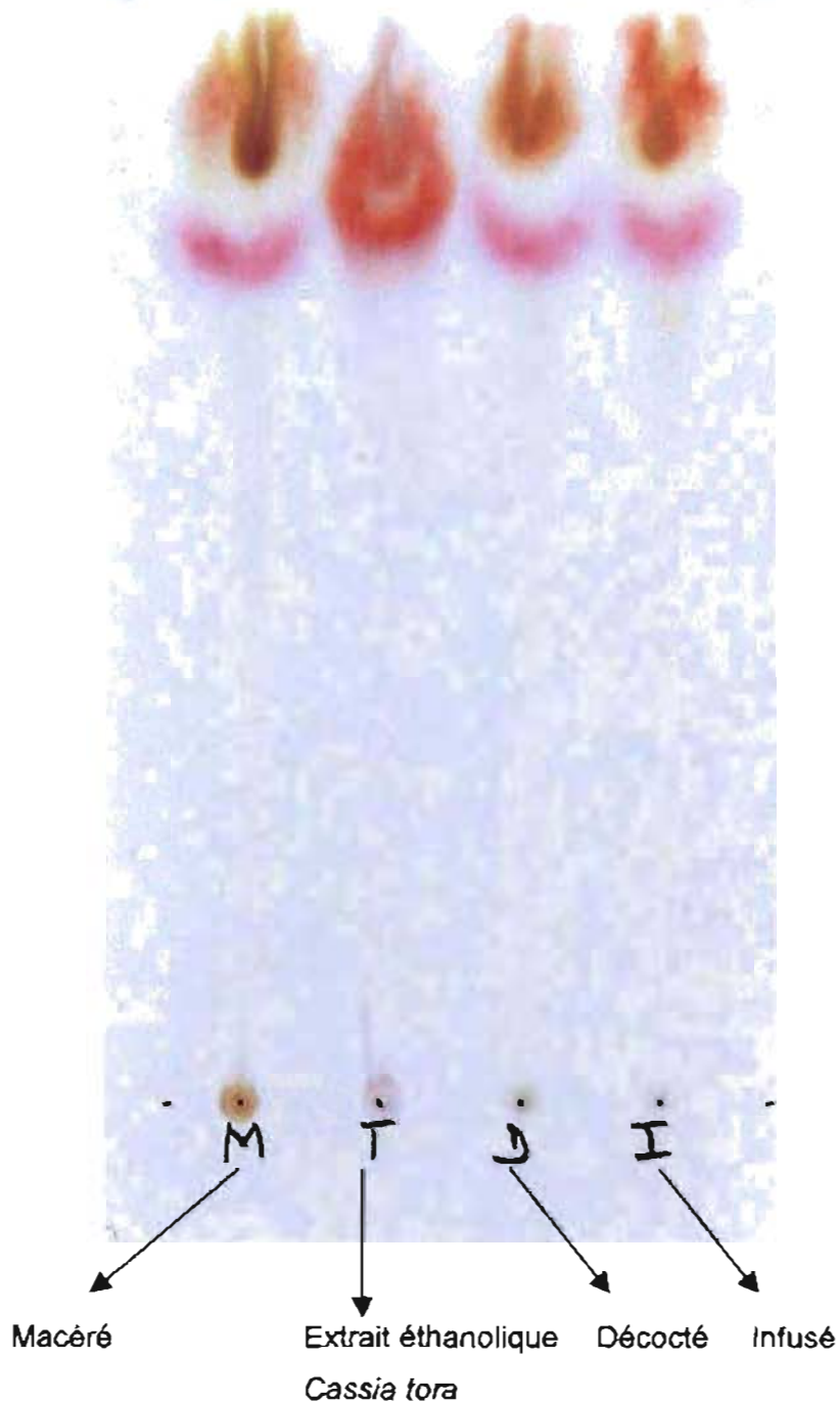
Figure 7 : Chromatogramme des anthracénosides aglycones des hydrolysats des extraits aqueux (décocté, infusé, macéré) de Saye .
