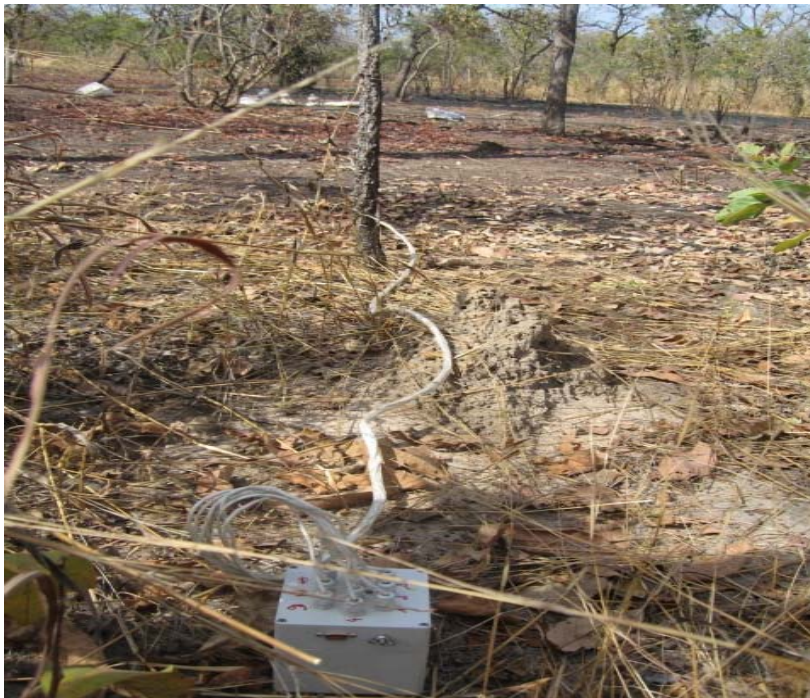
Photo 4 : Dispositif de mesure de la température du feu avec les senseurs et le Datalogger MinCube.
