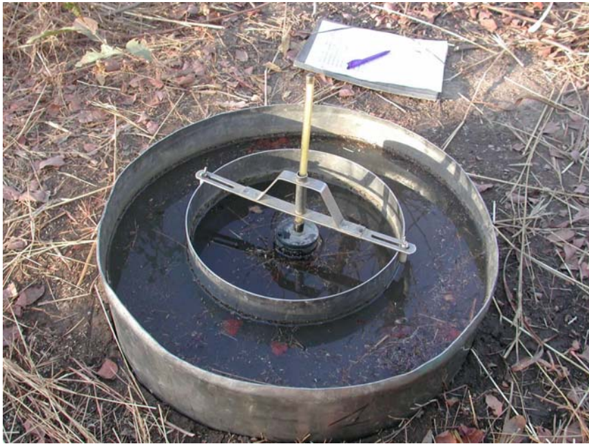
Photo 3 : Mesure de l'infiltration à Tiogo à l'aide de l'infiltromètre à double anneaux.
