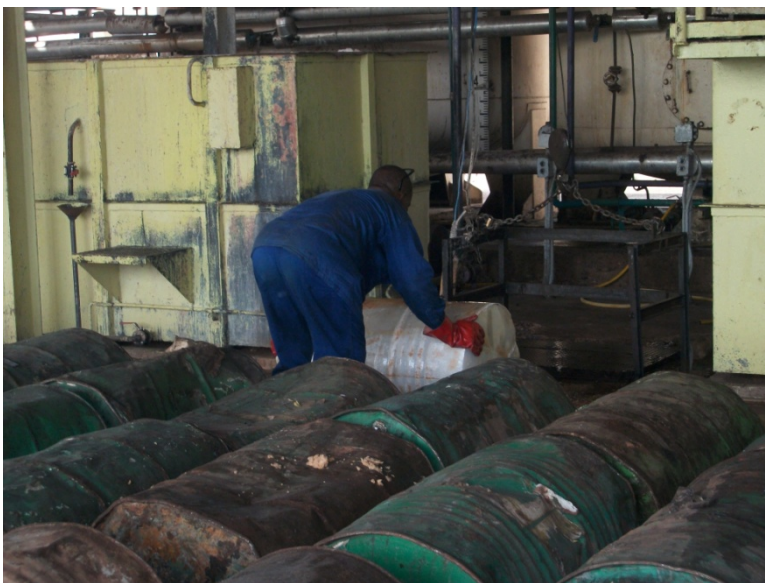
Figure 13 :Ouvrier poussant la soude sous forme solide pour sa fonte (J.N. GUISSOU le 26/05/11)
