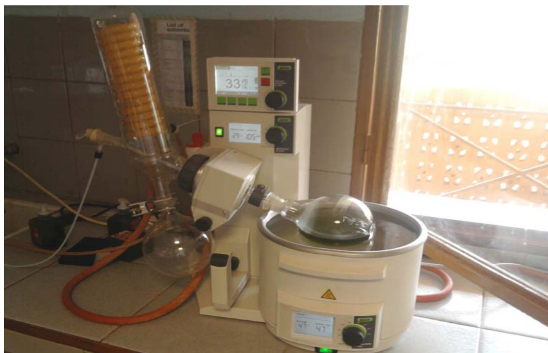
Figure 10 : Photo du Rotavapor utilisé pour concentrer sous vide les extraits de S. persica
