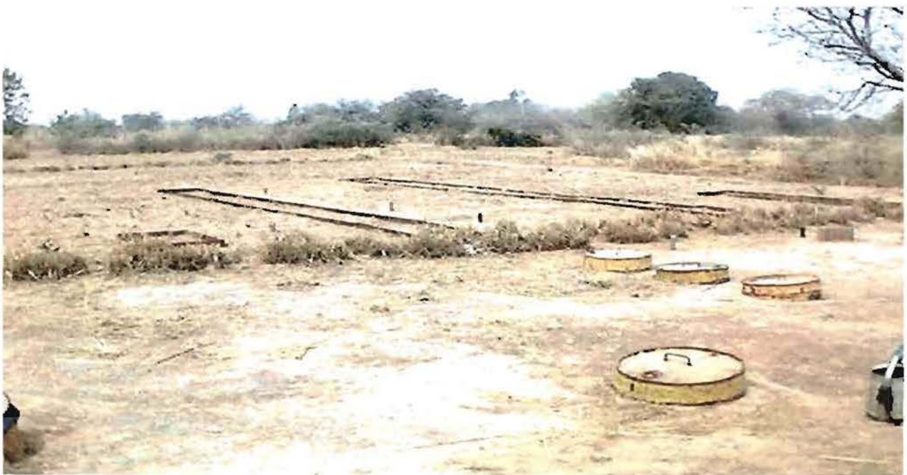
Figure N°4: Parcelle d'essai protégée par une bande végétative d' Andropogon gayanus taillé de laquelle partent quatre placettes de ruissellement avec à leurs côtés des tubes de trime. Quelques fûts de collecte d'eau de ruissellement
