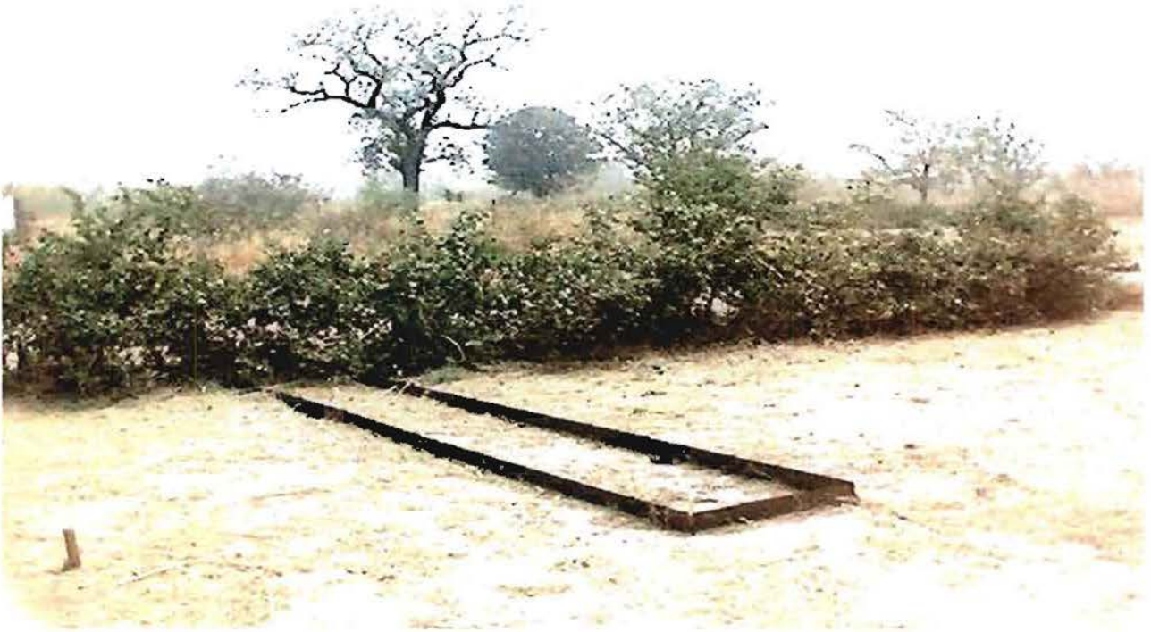
Figure N°1: Parcelle protégée par une bande végétative de Piliostigma thonningii d'où débouche une placette de ruissellement avec à côté un tube de trime (mesure d'humidité du sol).
