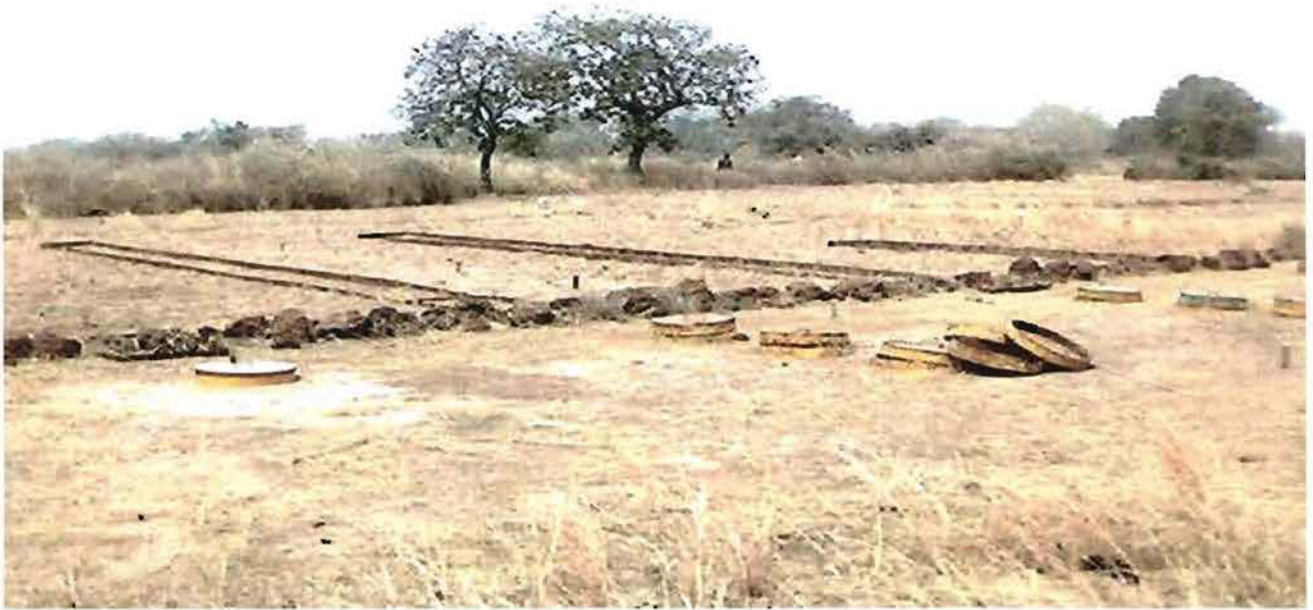
Figure N°3: Parcelle protégée par un cordon pierreux d'où partent des placettes de ruissellement avec leurs fûts de collecte des eaux de ruissellement en aval
