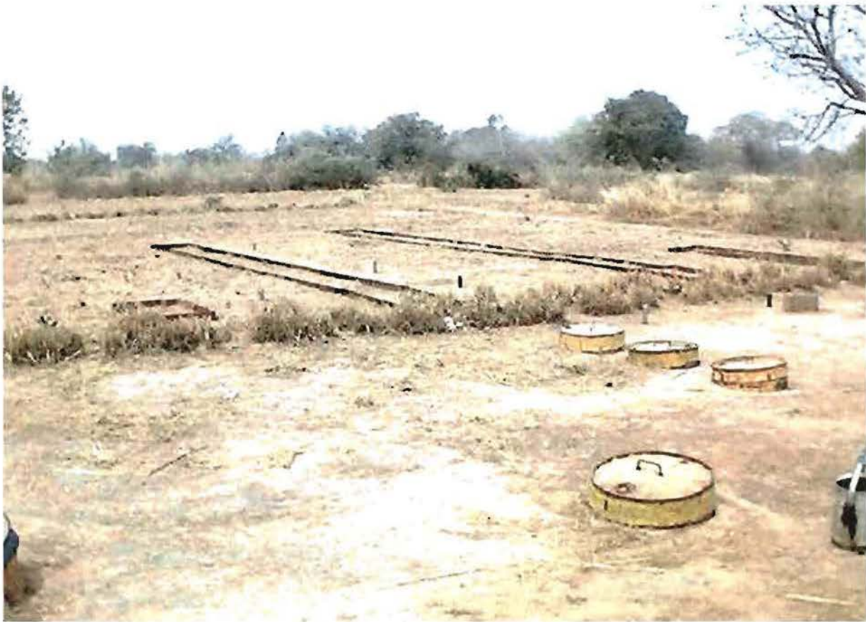
Figure N°2: Vue de placettes de ruissellement en tôle
