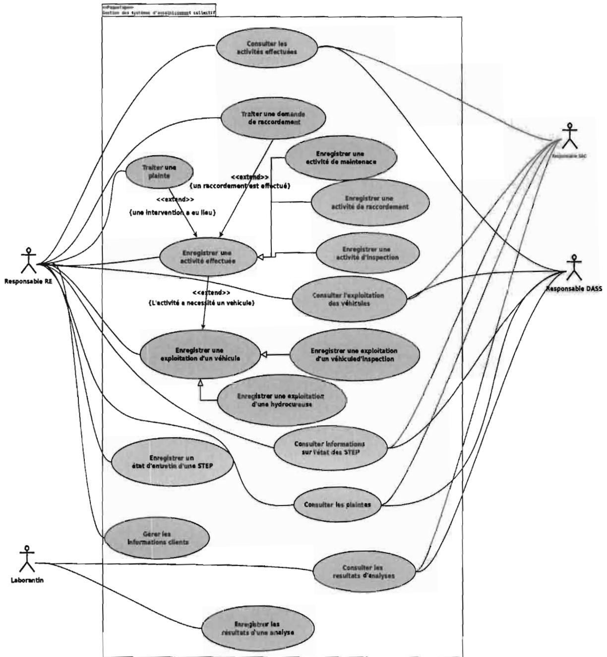
Figure 5 : Diagramme de cas d'utilisation du paquetage « Gestion des systèmes d'assainissement collectifs »
