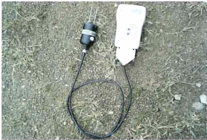
**Photo 2 : TDR pour la mesure du taux d'humidité**
