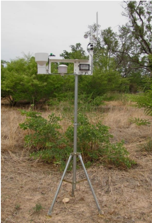
Photo 9 : Aperçu du Weather Station-GP1 munie d'un data logger (Delta T GP1) (Photo : S. Santi 2010).
