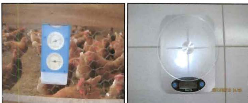
Figure 7 : Thermomètre – hygromètre et peson (sensibilité 1g)
