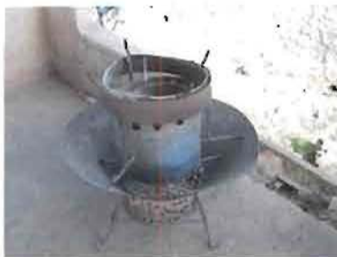
Photo n°4 : Modification de la hauteur du cylindre externe et du réservoir à balles de riz.
