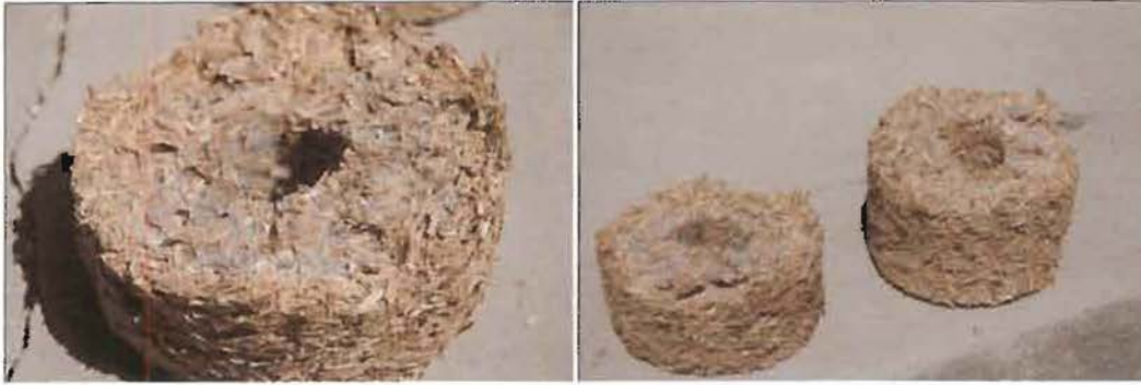
Photos e et f : Développement de moisissures dans les briquettes de 9,5 cm
