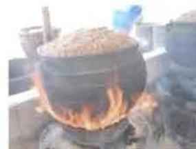
Photo n°8 : Fuite excessive de flamme
