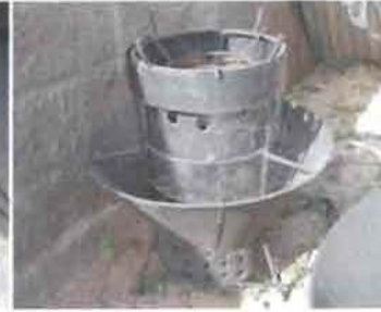
Photo n°3 : Modification de la hauteur du cylindre externe et de ses supports de maintien
