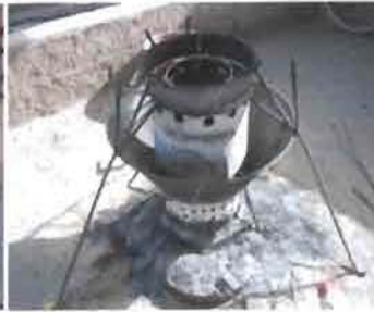
Photo n°2 : Foyer multifonctionnel (fonctionnant avec marmites et fûts)
