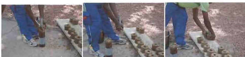
Retrait de la briquette du moule et dépôt sur la planche pour être séché au soleil
