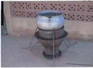
Foyer a balles de riz prototype2 conçu en 2008.
