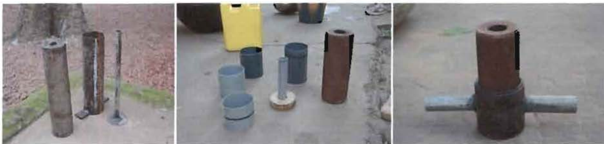
Les trois types de moules testés au cours des différents essais de briquetages
