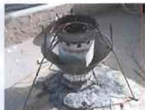
Photo n°1 : Foyer multifonctionnel (fonctionnant marmites et fûts)
