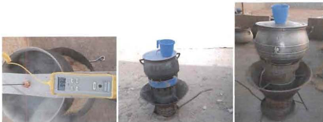
Thermocouple numérique, gobelet de 1 litre et les deux prototypes de foyer portant leurs marmites respectives.
